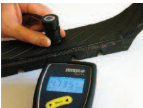
타이어 내부와 까지의 고무두께 측정 (최대 6.5mm) 프로브 F 10-2 사용
