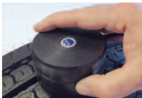
달리는 표면부터 그물망까지의 고무두께측정(최대 30mm) 프로브 F 30-T사용
