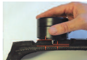
드레드의 홈 아래 드레드에서 그물망까지 두께측정(최대10mm) 프로브 F30-T 와 금속핀 사용
