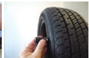
타이어 측면의 바깥에서 철심까지의 고무두께측정(최대 6.5mm) 프로브는 F10-1
