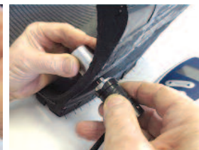
직물뼈대를 가진 측면의 토탈 고무두께측정(최대 10mm) 프로브 F10-cp와 철편사용
