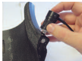
비드에서 그물망까지의 고무두께 측정(최대 6.5mm) 프로브 F10-3사용
